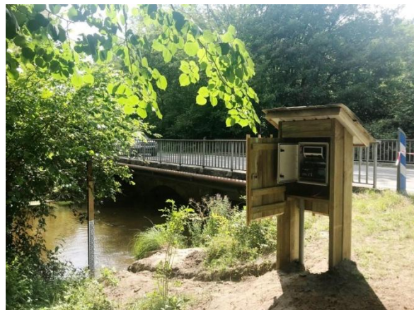
Photo 1 et 2.- Installation de la station hydrométrique de La Palue (pont D652, St-Michel-Escalus)
